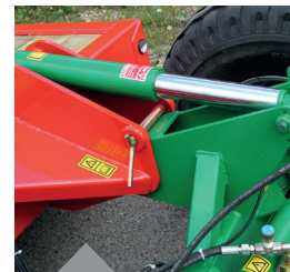
Vérins de montée et descente du plateau
